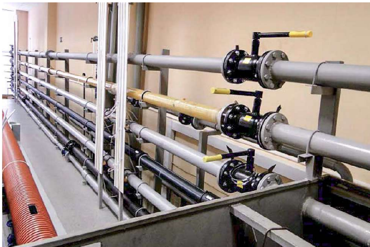
Рис.1. Общий вид гидравлического стенда с исследуемыми трубами.
