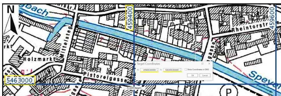
Figure 3. Insertion des coordonnées de l'intersection des axes cartésiens de la grille dans l'outil de géoréférencement. Les coordonnées sont indiquées en jaune.
