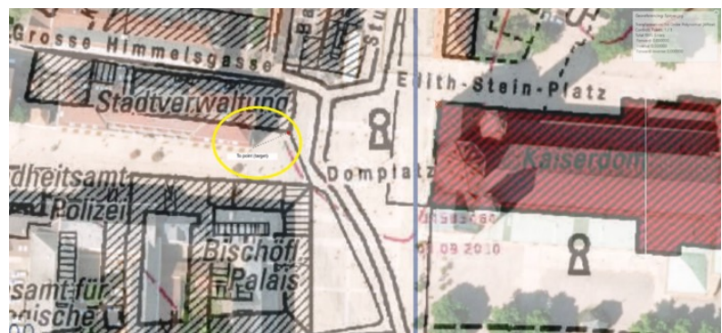
Figure 8. L'angle d'un bâtiment est utilisé comme point de contrôle. Nous cliquons d'abord sur le point de contrôle voulu sur l'image raster, puis sur ce même point sur le fond de carte.
